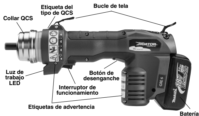
Figura 1 – GRE 6: Use el acoplamiento QCS para colocar el cabezal
